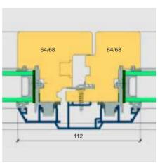
L'épaisseur de la partie centrale ne dépasse pas 112 mm, ce qui donne à la fenêtre toute sa ?nesse et son élégance. Grâce à une statique optimale, il est néanmoins possible de créer des façades vitrées de grande surface, également en combinaison avec un système poteaux/traverses.
